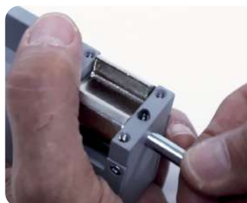
2.4 - Volver a insertar el pasador y apretar el tornillo.
