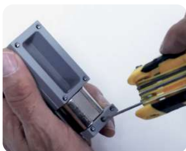
2.1 - Desatornillar el tornillo de seguridad.
